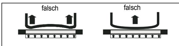
Falsch: der Geschirrboden ist gewölbt. Die Temperatur kann von der Elektronik nicht korrekt ermittelt werden.
