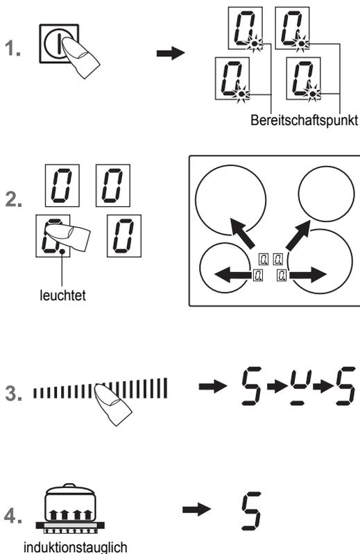
1. **Ein-/Aus-Taste** solange betätigen (ca. 1 Sek.), bis die Kochstufen-Anzeigen 0 zeigen und ein kurzer Signalton ertönt. Die Bereitschaftspunkte blinken. Die Steuerung ist betriebsbereit.
