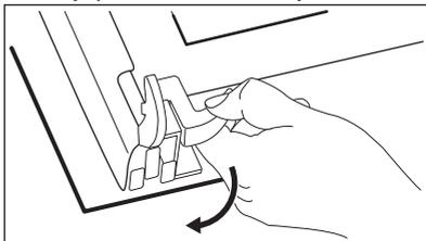
6. Поверните два фиксатора на 90° и извлеките их из своих гнезд.
