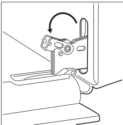
3. Прикройте дверцу наполовину до первого фиксируемого положения. Затем вытяните дверцу вверх и вперед из ее гнезда.
