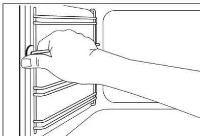
2. Вытяните заднюю часть направляющей из боковой стенки и снимите ее.
