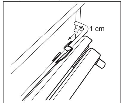
3. Поверните направляющую в надлежащее положение. Стопоры на концах телескопической
