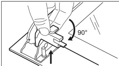
7. Сначала осторожно поднимите и выньте стеклянную панель.
