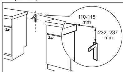
2. На задней стороне прибора найдется отверстие с левой стороны. Поднимите переднюю часть прибора и поместите его в центр пространства между шкафами. Если расстояние между кухонными шкафами больше, чем ширина прибора, следует установить ее так, чтобы зазоры с обеих сторон были одинаковыми.
